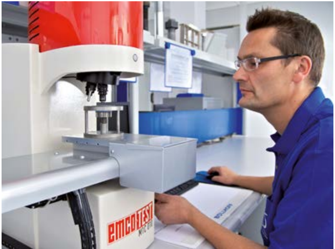
Bild 3.11 Härteprüfung im Labor in Bielefeld
