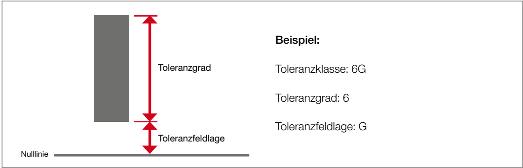
Bild 6.4 Toleranzsystem nach DIN ISO 965-1
