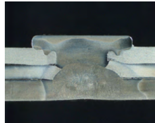
Al6xxx Blech 1,2 mm Stahl Tiefziehgüte 1,0 mm Pressgehärteter Stahl 1,6 mm
