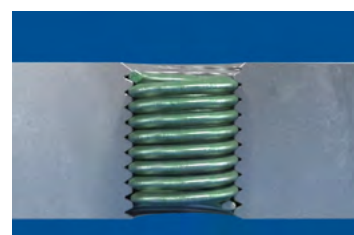
Installation correcte de l'HELICOIL® Plus (0,25-0,5 x P sous la surface du composant)
