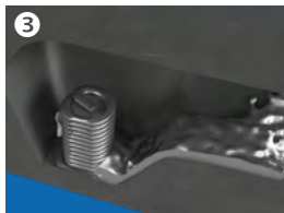
Coulée de l'aluminium liquide fondu dans la cavité sans pression à l'aide de machines de dosage ou manuellement à partir d'une poche de coulée.
