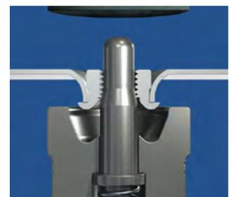
Der Verbund aus Einnietmutter und Bauteil wird durch den zurückfedernden Zentrierstift aus der Matrize gehoben und kann von dem Anwender aus dem Werkzeug entnommen werden.
