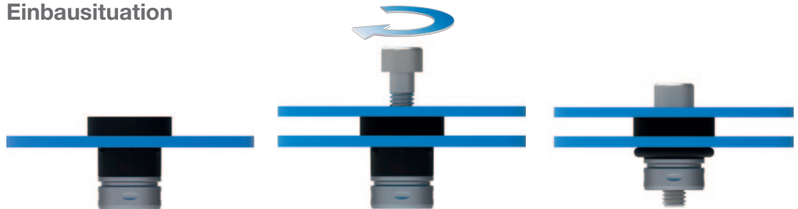
Eindrücken in das Aufnahmebauteil
