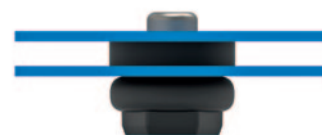
SITEC® Rivet mit abgeschlossenem Verschraubungsvorgang = Setzvorgang
