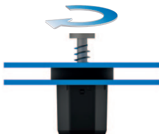
Auflagen der zu befestigenden Komponente und mit gewindefurchender Schraube verschrauben
