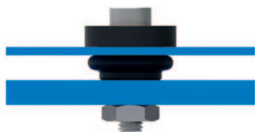
SITEC® Rivet ohne Gewinde, im eingebauten Zustand
