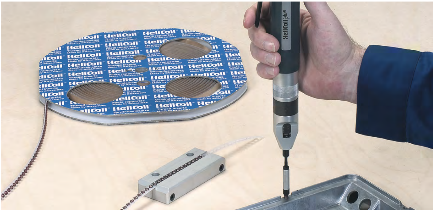
Einbau des HELICOIL® Plus
