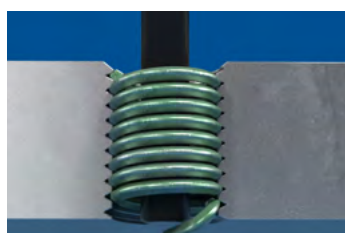
Um ein Durchgangsgewinde zu generieren, wird der Mitnehmerzapfen an der Kerbe mit dem Zapfenbrecher gebrochen.
