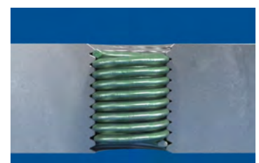
Korrektter Einbau des HELICOIL® Plus ( 0,25 - 0,5 \times P unter die Bauteiloberfläche)
