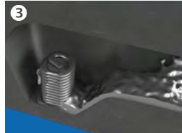
3 Eingießen der flüssigen Aluminiumschmelze in die Füllkammer ohne Druck mittels Dosierautomaten oder von Hand mittels eines Schöpföffels.
