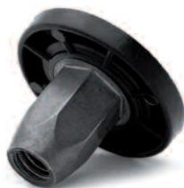
Grâce à une bague plastique surmoulée ou rapportée sur la tête d'un RIVKLE®, celui-ci peut isoler une pièce électriquement pour la cataphorèse.
