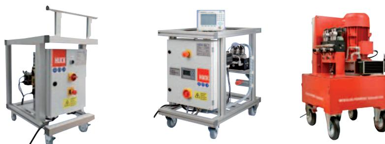
Il existe 3 options de Powerig™ électrique pour une utilisation avec les outils de pose hydrauliques. BÖLLHOFF préconise l'utilisation du groupe hydraulique HK32-002 (voir p. 87).
