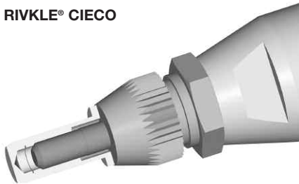
Figura 6 – Regolazione della posizione del cono
