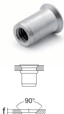
Aço inoxidável | Cabeça escareada | Liso | Aberto
