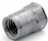
Aço inoxidável A4 | Cabeça fina | Semi hexagonal | Aberto
