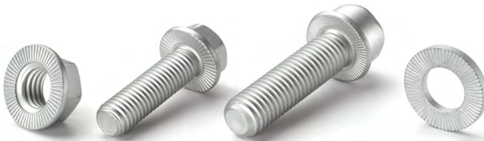
Bei der Montage des Verbindungselements prägen sich die Radialrippen der RIPP LOCK® Elemente in die jeweilige Gegenauflage ein. Der dadurch entstehende Formschluss verhindert das selbsttätige Lösen der Verbindung.
