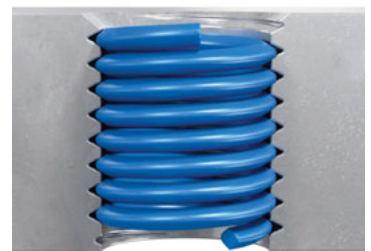
HELICOIL® Smart korrekt montiert (0,25 – 0,5 x P unter die Bauteiloberfläche)
