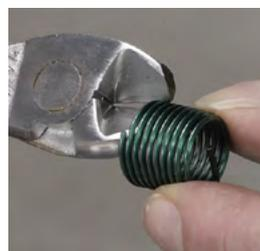
Die Auswahl des HELICOIL® Plus mit der entsprechenden Windungszahl „W“ erfolgt über die Einbaubeschreibung. Bei Bedarf wird der HELICOIL® Plus mit einem Seitenschneider gekürzt.
