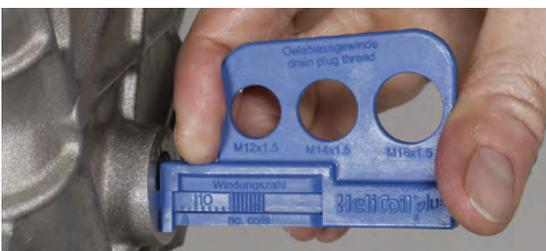
Nach dem Schneiden des HELICOIL® Plus Aufnahmegewindes ermittelt man mit dem Messschieber die Anzahl der benötigten Windungen des einzusetzenden HELICOIL® Plus.
