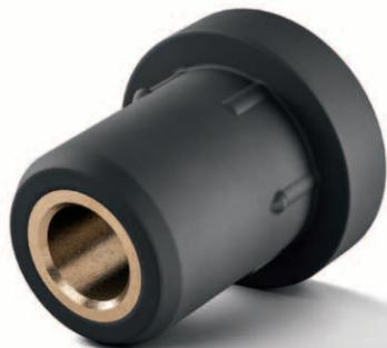
Solution d'assemblage par sertissage avec surmoulage en élastomère. Il amortit les vibrations et le bruit provoqué par le moteur de la pompe à chaleur et offre une résistance à la déformation grâce à son isolation thermique et électrique.
