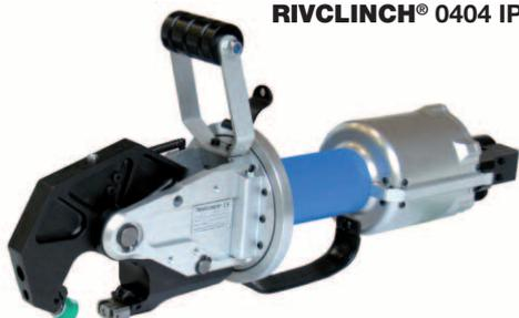
Dans l'objectif d'assurer la résistance de la pompe à chaleur, nous avons sélectionné la machine RIVCLINCH® 0404 IP. Cet outil de pose parfaitement adapté au clinchage, est directement prêt à l'emploi ("plug-and-play").
