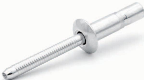
Solution d'assemblage de manière permanente pour les pièces de faibles épaisseur. Le rivet de structure multiserrage tête plate garantit une fixation optimale de l'ossature de la pompe à chaleur lorsque l'accès à l'arrière est difficile. Il assure une fonction anti-vibration et anti-corrosion.
