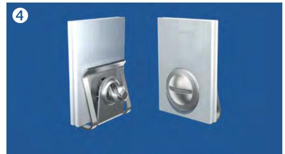
Einsetzen des Bolzens in die Aufnahme. Zum Verriegeln der Verbindung ist eine halbe Umdrehung erforderlich. Durch Zurückdrehen wird die Verbindung gelöst.
