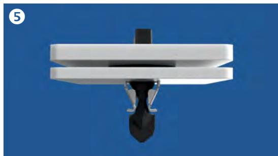
Beim Öffnen durch eine Vierteldrehung nach rechts oder links wird der elastische Bereich des Verschlussunterteiles gedehnt, so dass der Verschlussbolzen wieder freigegeben wird.
