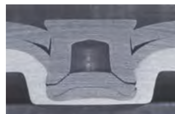
Acero endurecido 1,35 mm Acero de embutición profunda 1,0 mm Aluminio 2,0 mm
