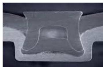
Acero endurecido 1,8 mm Adhesivo Aluminio 2,0 mm
