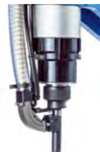
Dispositivo de apriete EH: Conjunto mecánico integrado
