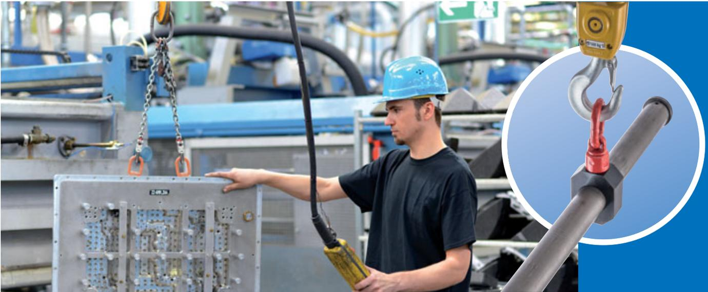
Beim Transport von Lasten werden hohe Anforderungen an die Sicherheit gestellt. Hochfeste Anschlagpunkte bieten dabei deutliche Vorteile gegenüber konventionellen Anschlagmitteln hinsichtlich Sicherheit und der maximal zulässigen Traglasten. Zudem sind unsere Anschlagpunkte auch nach der Montage einfach und schnell ausrichtbar, so dass ein optimaler Kraftangriff erreicht wird.
