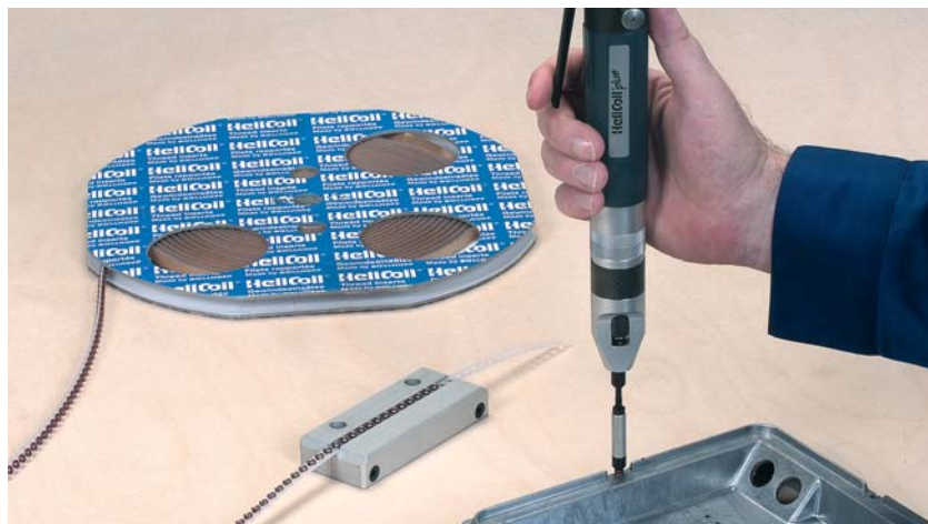
Colocação do HELICOIL® Plus
