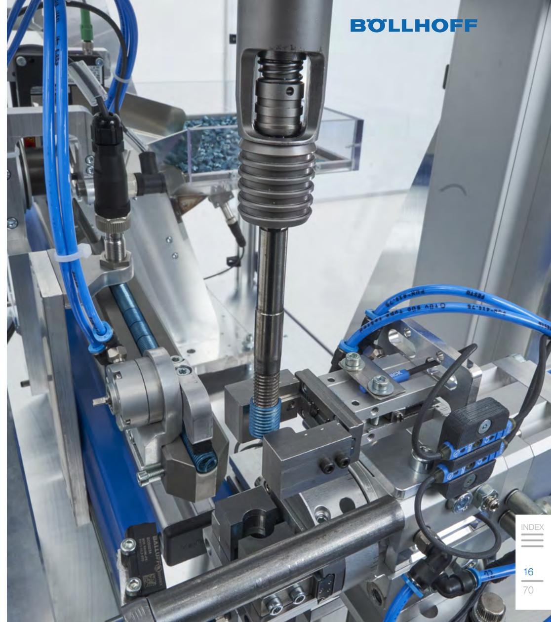
HELICOIL® Gewindeeinsätze sorgen für hochbelastbare Verbindungen in Werkstoffen geringer Scherfestigkeit – etwa in Aluminium und Magnesium oder auch in faserverstärkten Kunststoffen. Möglich wird dies durch das Übertragen der Kräfte von Flanke zu Flanke in das Aufnahmegewinde.
