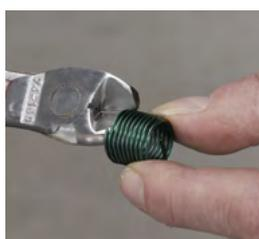
Die Auswahl des HELICOIL® Plus mit der entsprechenden Windungszahl „W“ erfolgt über die Einbaubeschreibung. Bei Bedarf wird der HELICOIL® Plus mit einem Seitenschneider gekürzt.
