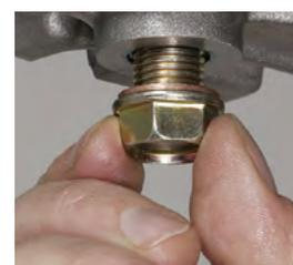
Für die vorhandenen Verschlussstopfen mit Bund besteht eine ausreichend große Dichtringauflage. Sonderverschlussstopfen sind nicht erforderlich.
