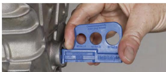
Nach dem Schneiden des HELICOIL® Plus Aufnahmegewindes ermittelt man mit der Schieblehre die Anzahl der benötigten Windungen des einzusetzenden HELICOIL® Plus.
