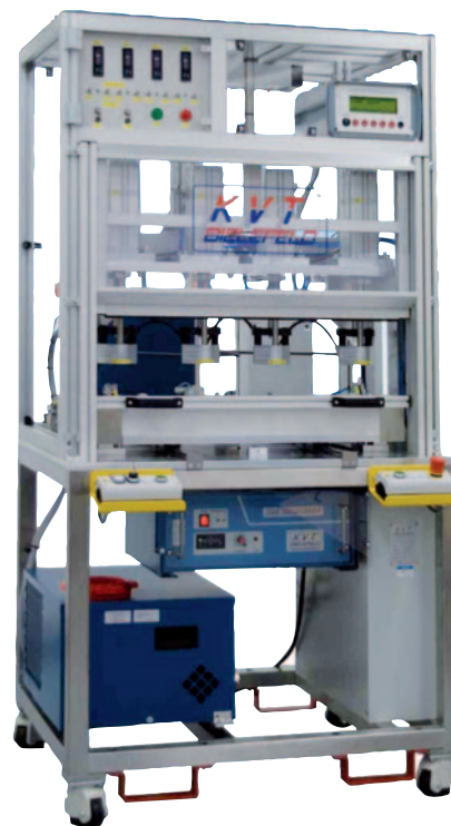
EWS-Warmeinbaumaschine zum Einbetten von vier HITCERT® Gewindeeinsätzen in eine Kofferraumgriffleiste
