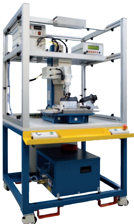
Máquina para la colocación por calor (ERW) de insertos roscados HITSERT® en los componentes de un motor de automóvil.
