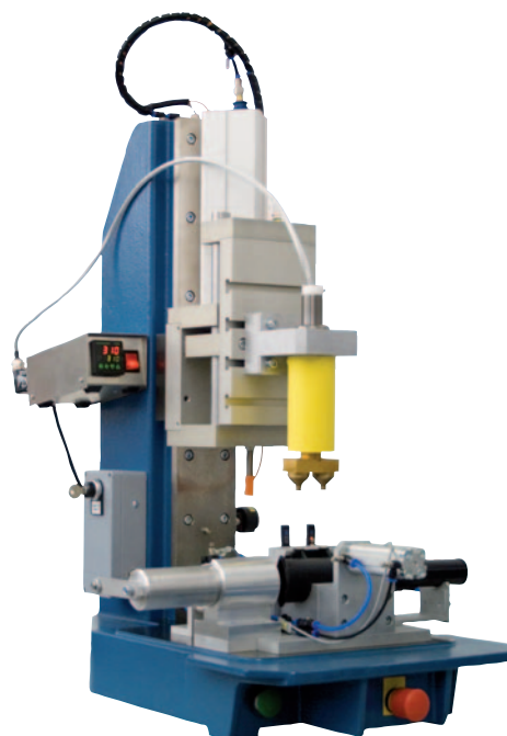
Máquina para la colocación por calor (ERW) de cuatro insertos HITSERT® en un sistema de arranque de automóvil.
