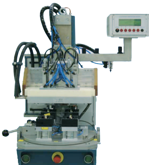
Máquina de colocación por calor (ERW) de ocho insertos HITSERT® M 1.6 en dos carcasas de un teléfono móvil.
