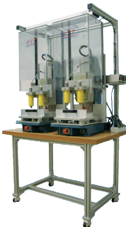
Máquina KVT Basic 5000 DUO para la colocación simultánea por calor de cuatro insertos HITSERT® en la parte exterior de dos espejos retrovisores.
