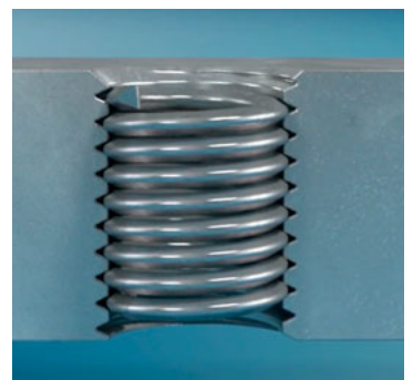
HELICOIL® Tangfree korrekt montiert (0,25 – 0,5 x P unter der Oberfläche)
