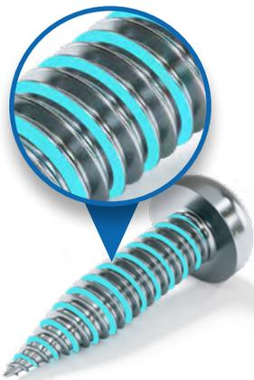
Das geschaffene Aufnahmegewinde erhält aufgrund des generierten Durchzugs eine günstigere Bauhöhe am Verschraubungspunkt. Die Gewindesteigung ist feiner als bei klassischen Blechsschrauben, das heißt, es ist eine ausreichende Überdeckung der geformten Gewindeflanken gegeben. Die QUICK FLOW® Plus Dünnschraube besitzt zudem ein doppelgängiges Gewinde. Somit wird die Fläche, die sich im Eingriff befindlichen Gewindeflanken, zusätzlich erhöht.
