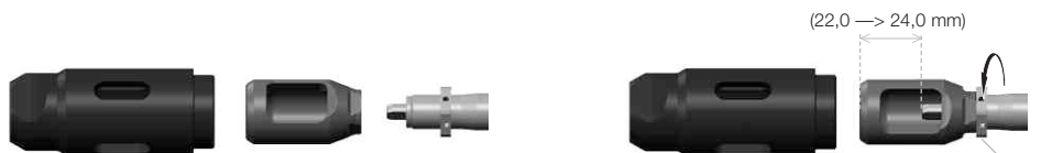
Figura 3 - Bussola e Naso per prigionieri con forza >18 kN (M8 & M10)
