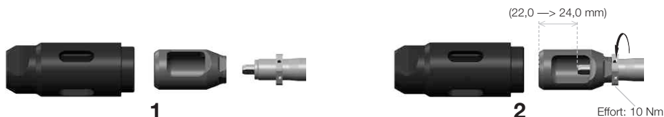
Figure 3 - Fourchette et nez pour RIVKLE® Goujon et effort >18 kN (M8 & M10)
