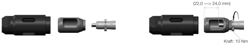
Abbildung 3 - Gewindedornaufnahme und Mundstückhalter für Blindnietverschraubung oder einer Nietkraft >22 kN (M8 & M10)
