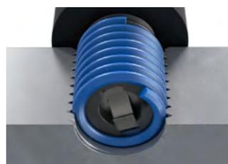
Einfahren der Klinge und Herausdrehen der Einbauspindel
