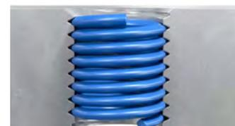
Korrekter Einbau des HELICOIL® Smart (0,25–0,5 x P unter die Bauteiloberfläche)
