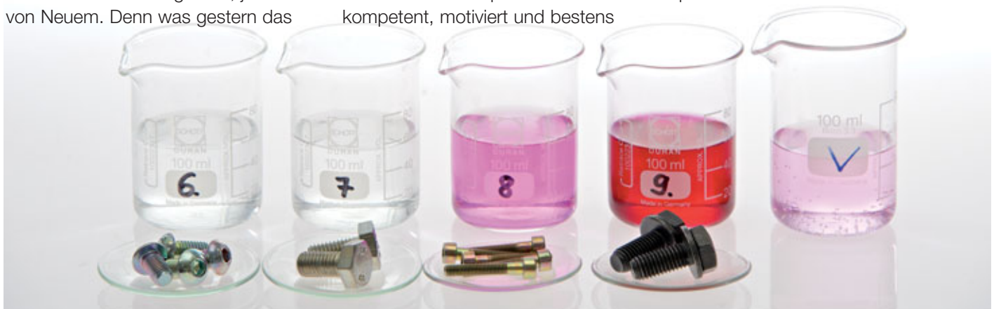
Laborprüfung zur Bestimmung von Cr 6+ in Korrosionsschutzschichten
