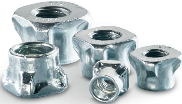
Las KAPTI NUT® son una solución de fijación mediante tuercas roscadas insertables de gran resistencia. Permiten fijar de manera permanente a un panel o componente una variedad de tuercas a través de un proceso de colocación mecánico. El sistema resulta especialmente adecuado para la colocación (por prensa) de múltiples tuercas en chapas de acero y se puede utilizar sobre ciertas aleaciones de aluminio y acero inoxidable.
