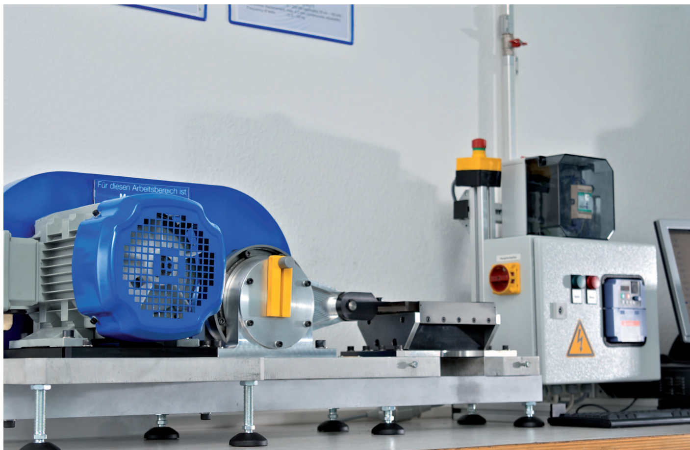
Platforma testowa do wibracji w laboratorium Böllhoff
