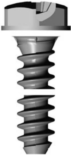
Die Zentrierrippen unterhalb des Kopfes bewirken eine Zentrierung der K' in K' Schraube in der Bohrung des zu befestigenden Bauteiles. Sie formen sich beim Schraubvorgang an die Wandung der Aufnahmebohrung und stützen die Verschraubung bei geringer Querlast.
